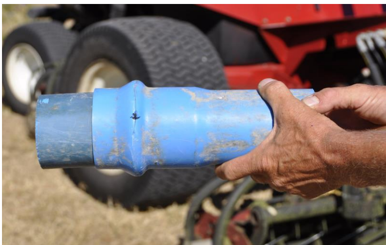
Detta är orsaken, gamla polska plastskarvar som ligger på en och en halv meters djup runtom på banan.
